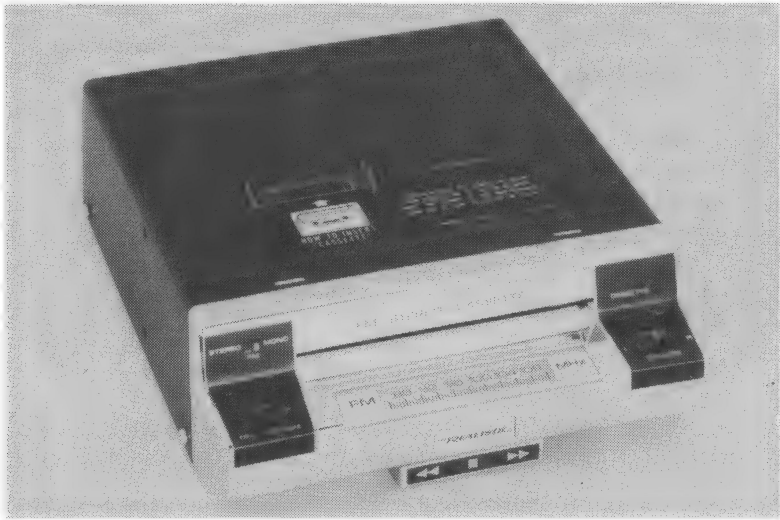
Fig. 10-2. Combination auto cassette/fm radio.
